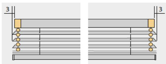
Befestigungsmöglichkeiten der Seilführung
