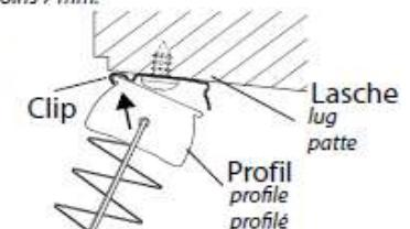
Zur Demontage drücken Sie die Lasche des Clips hoch, um das Profil aus dem Clip entnehmen zu können.
