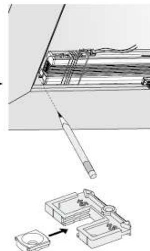
Montagehilfe je nach Fenstertyp – wie bereits bei den Clips beschrieben – mit "+5" oder "+3" an die Vorderkannte des Fensters und Ihrer Markierung der Plisseebreite anlegen. Clips festschrauben. Montagehilfe abziehen.
