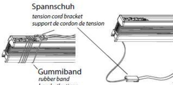
Gummiband entfernen und die Spannschuhe abwickeln.
