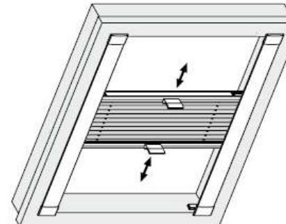
Gespannte Plissee-Anlagen schließen bzw. öffnet man durch Verschieben des Bediengriffes.
