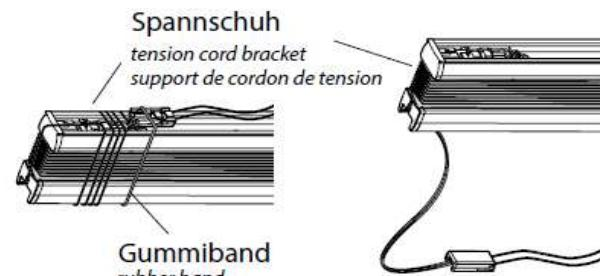
Gummiband entfernen und die Spannschuhe abwickeln
