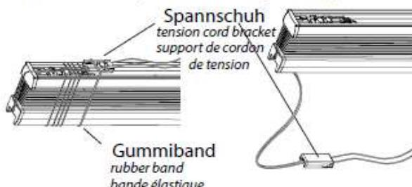
Gummiband entfernen und die Spannschuhe abwickeln
