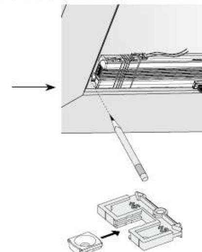
Montagehilfe je nach Fenstertyp – wie bereits bei den Clips beschrieben – mit "+5" oder "+3" an die Vorderkannte des Fensters und Ihrer Markierung der Plisseebreite anlegen. Clips festschrauben. Montagehilfe abziehen.
