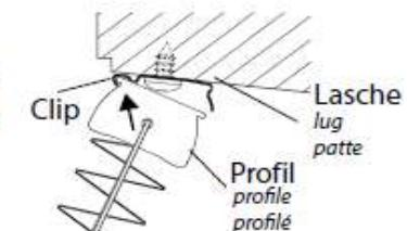
Montage: Die Kante des Profils schräg in den Clip (gegenüber der Lasche) einsetzen und dann in den Clip hinein schwenken bis es einklickt.
