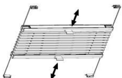
Gespannte Plissee-Anlagen schließt bzw. öffnet man durch verschieben des Bediengriffes.
