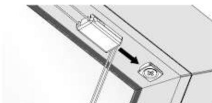
oberen Spannschuhe auf die oben montierten Befestigungsplättchen schieben, bis sie einrasten
