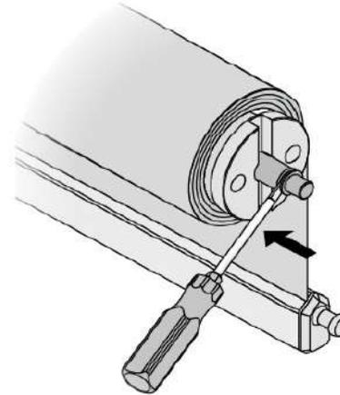
Anschließend den Zylinderstift mit einem Schraubendreher in die Rollo-welle eindrücken und das Rollo aus den Trägern nehmen
